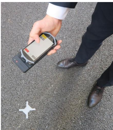
IC タグ読み取りイメージ (左：ロケーション管理用タグ/右：積層ラベル)
