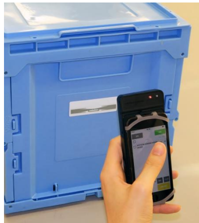
IC タグ読み取りイメージ (左：ロケーション管理用タグ/右：積層ラベル)
